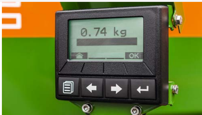
Калибровка с помощью терминала TwinTerminal 3.0
