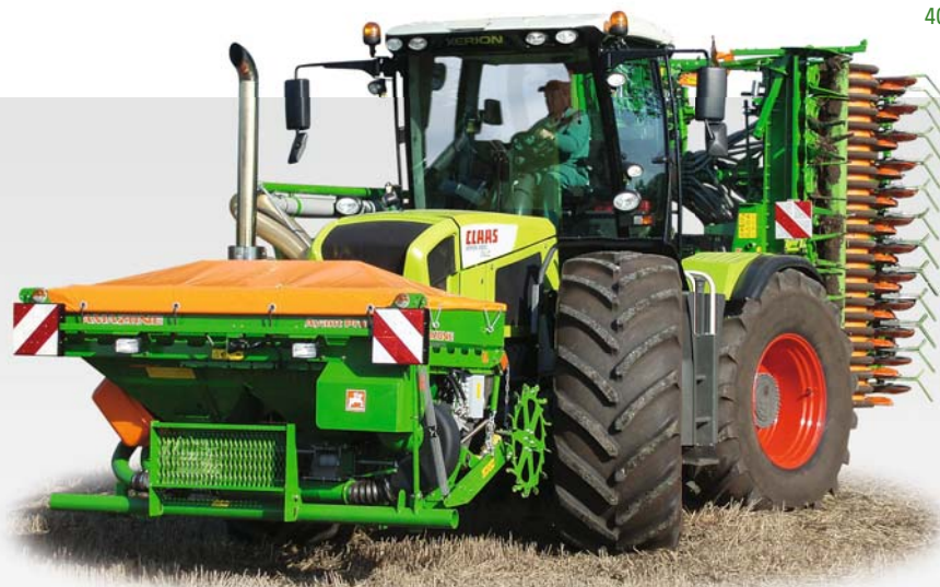
Avant 6001-2 с фронтальным семенным бункером FRS с фронтальной рамой и приводным колесом
