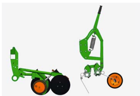
Прикатывающая балка в бездействии: Пальцевой загортач также покрывает посевной материал почвой.
