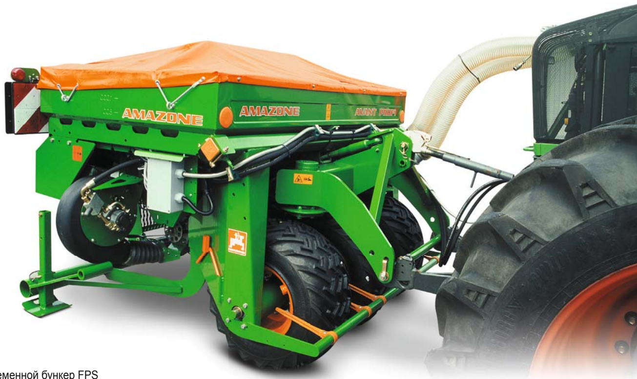
Фронтальный семенной бункер FPS с самоуправляемым фронтальным шинным пакером
