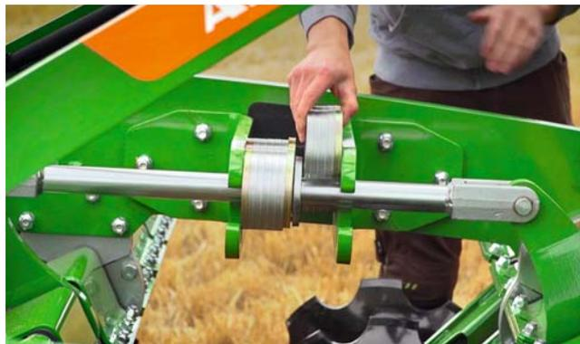
✔ Настройка глубины обработки с помощью регулировочных клипс – здесь средняя глубина обработки
