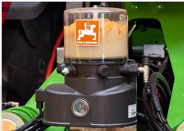
Насос с резервуаром для смазки
