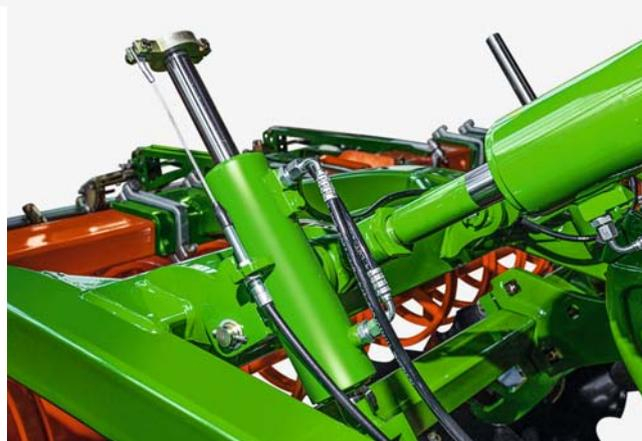
Централизованная гидравлическая регулировка выравнивающих элементов
