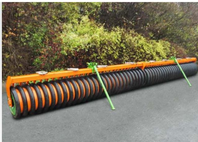
Демонтаж и хранение катка с помощью фиксатора
