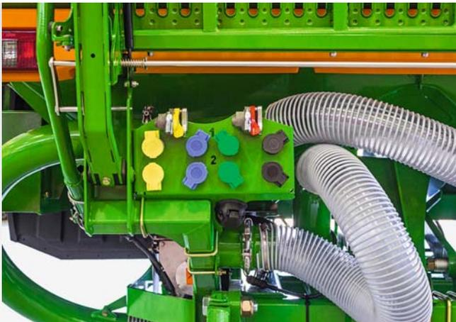
Сквозные коммуникации для подключения гидравлики и электрики
