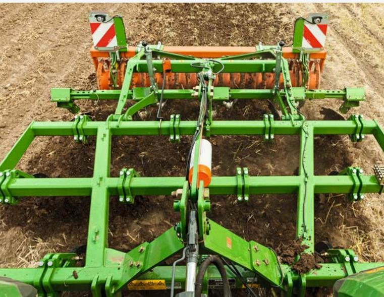
Трёхрядная конструкция рамы Cenius 3003 Special
