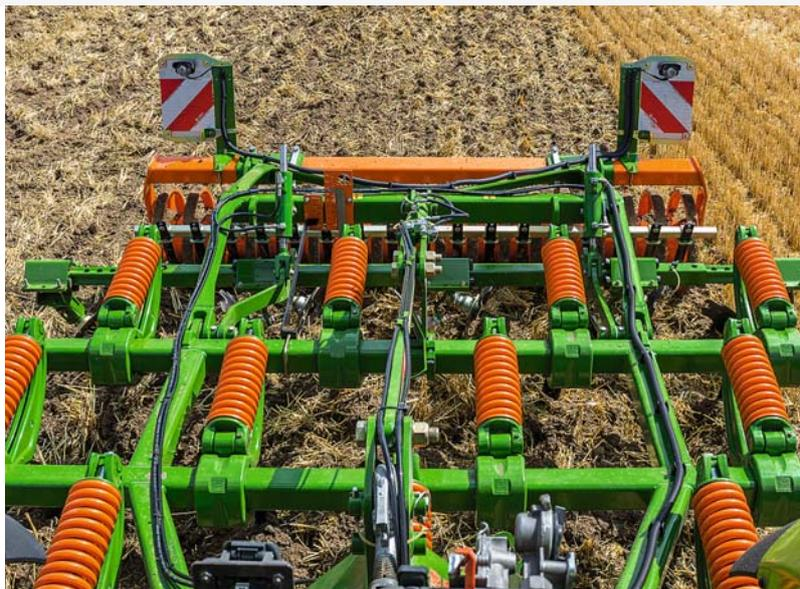
Трёхрядная конструкция рамы Cenius 3003 Super
