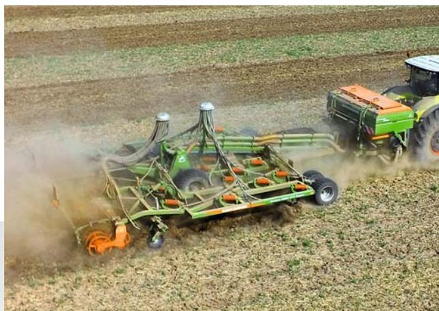
XTender 4200 с культиватором Cenius 6003-2TX и двумя магистралями подачи для внесения удобрений и посевного материала
