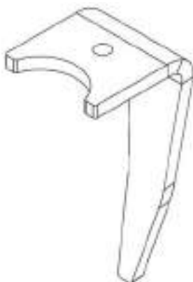
Зубья рабочего органа KG Special с агрессивным углом атаки (HD) (левостороннее вращение)
