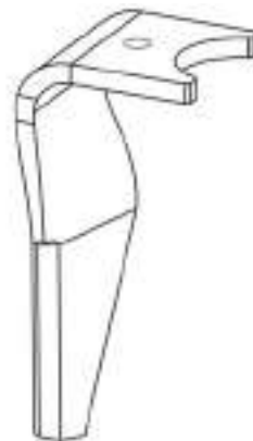
Зубья рабочего органа KG с пассивным углом атаки (левостороннее вращение)
