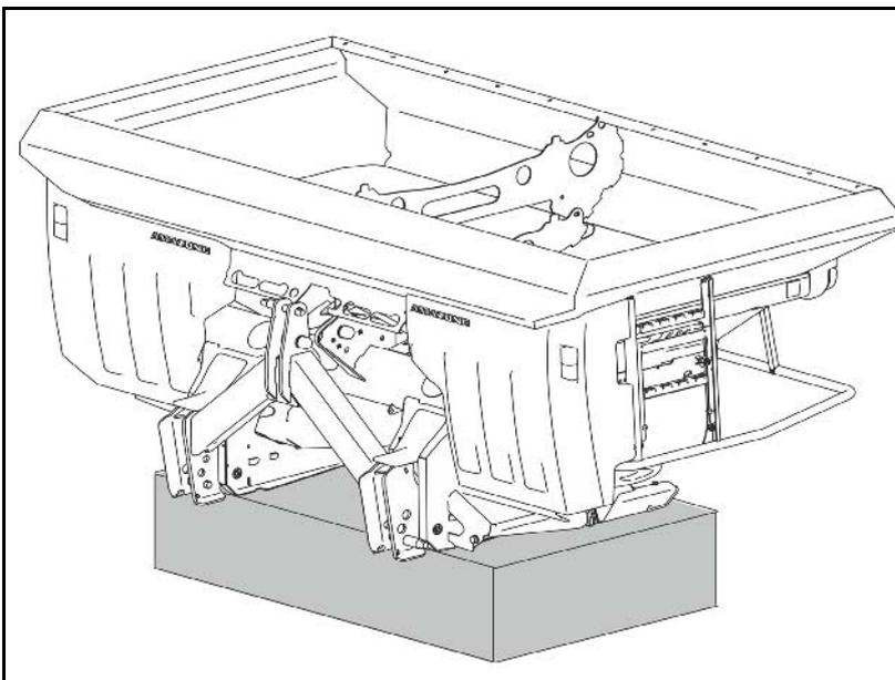
1. Устанавливайте на хранение отсоединенный агрегат обязательно с разгруженным бункером на горизонтальную поверхность с твёрдым грунтом.
