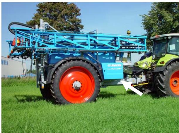
Заводская табличка агрегата находится на ходовой части.
