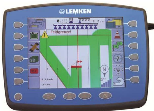
При помощи этого терминала управления ISOBUS можно контролировать и управлять агрегатом. Терминал управления позволяет производить передачу данных на внешний ПК при помощи USB-флеш-накопителя.
