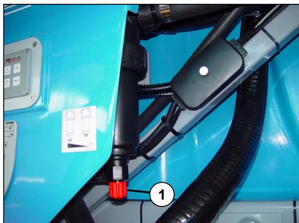
В автоматическом режиме промывочный клапан (1) должен быть отрегулирован по размеру распылителей.
