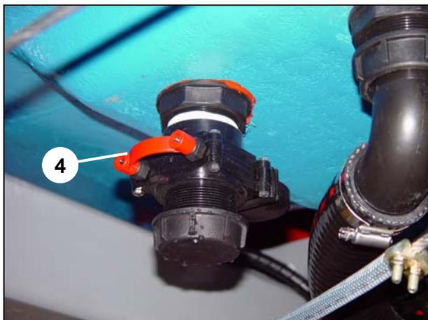
Из сливного крана (4) можно слить самотеком содержимое главного бака в соответствующий поддон или откачать внешним насосом.
