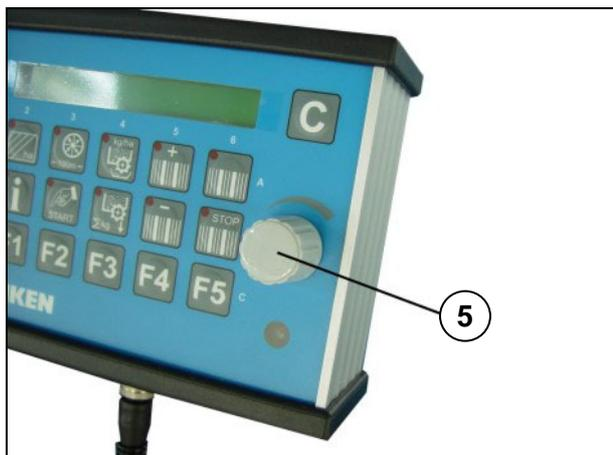
Значения и настройки выбираются с помощью поворотной ручки (5). В следующей части этого руководства встречаются указания "выбрать" или "ввести". При этом всякий раз имеется в виду пользование поворотной ручкой (5).
