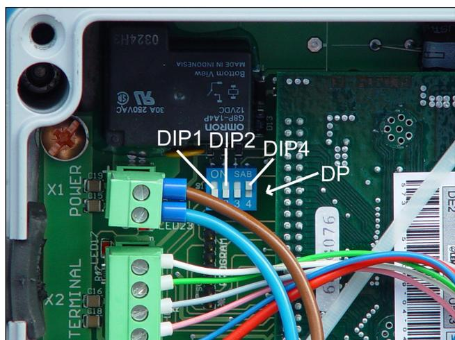
Система управления рядовой сеялки отрегулирована на заводе-изготовителе в зависимости от рабочей ширины и типа машины. Для этого двухпозиционные выключатели (DP) были переключены в положения "ON" ("вкл.") или "OFF" ("выкл.") в соответствии с разделом "Регулировка двухпозиционных переключателей". Если, однако, на дисплее появилось
