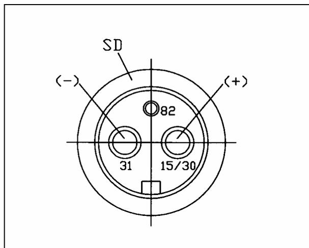
Для электропитания на тракторе должна иметься 3-полюсная розетка, соответствующая стандарту DIN 9680.
