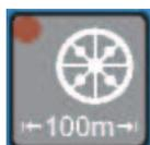
Клавиша калибровки - для калибровки 100 метров в "см на импульс".
