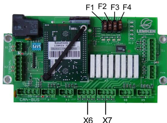
Состояние электродвигателей и клапанов можно считать на дисплее. Индикатор показывает напряжение, приложенное к контактам с 1 по 8 в гнездах разъемов X6 и X7 (слева направо).
