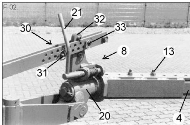
Чтобы во время поворота всегда обеспечивалось достаточное свободное пространство между катком FixPack и плугом, передний забивной штифт следует вставить как можно дальше сзади, перед направляющим упором (32).
