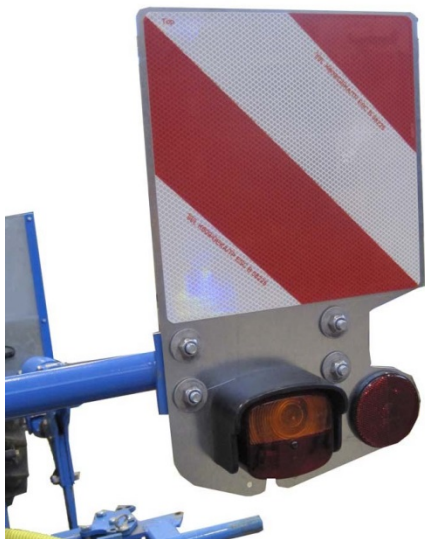
Осветительные приборы с предупредительными табличками спереди и сзади
