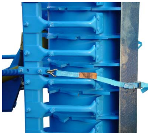
Защитное устройство зубчатого уплотняющего катка
