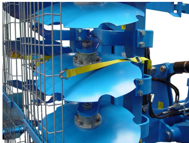
Защитные устройства полусферических дисков
