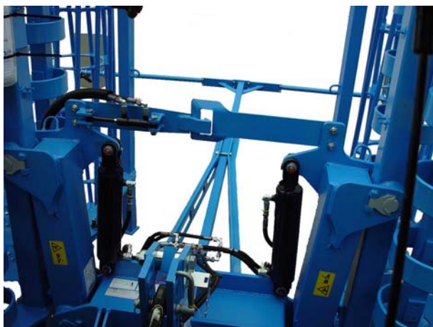
Гидравлическое устройство, предохраняющее от откидывания
