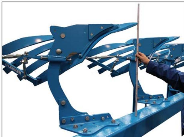
Все корпуса плуга установить на один и тот же угол атаки.
