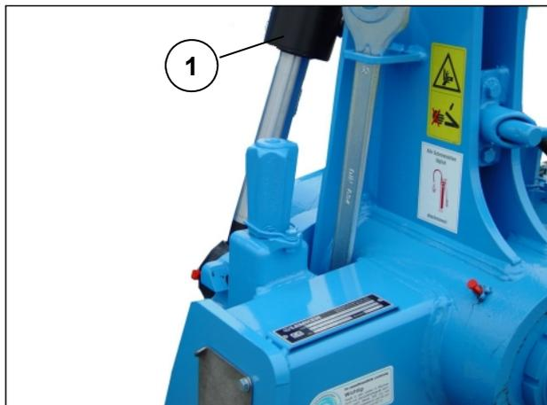
В сочетании с устройством управления простого действия, подключенным к поворотному цилиндру (1), с обратным сливом в масляный бак трактора угол наклона регулируется следующим образом:
