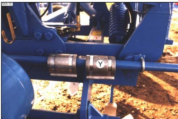
Рабочее положение, зажимные упоры (Y) надвинуты на передний держатель осветительной установки.
