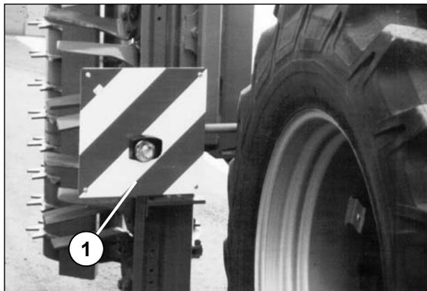
Агрегат может оснащаться комплектом осветительного оборудования с предупреждающими табличками (1). Осветительное оборудование должно быть установлено при выезде на дороги общего назначения.
