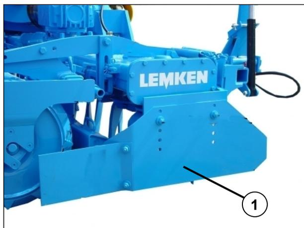
Вал отбора мощности трактора можно включать только в том случае, если ротационная борона опущена и находится на расстоянии всего нескольких сантиметров над почвой, а боковые щитки (1) не позволяют наступить на вращающиеся инструменты. Вал отбора мощности следует отключить, если расстояние между ротационной бороной и почвой превышает несколько сантиметров.
