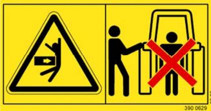
При пуске трехточечного силового подъемника находиться вне зоны хода трехточечного механизма навески.
