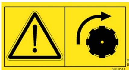
Сквозной привод вала отбора мощности вращается в правую сторону.
