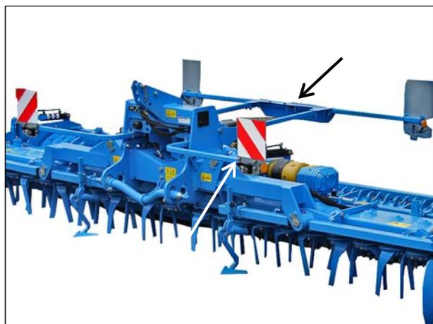
Осветительное оборудование с предупреждающими табличками находится спереди, сзади или спереди и сзади на агрегате.
