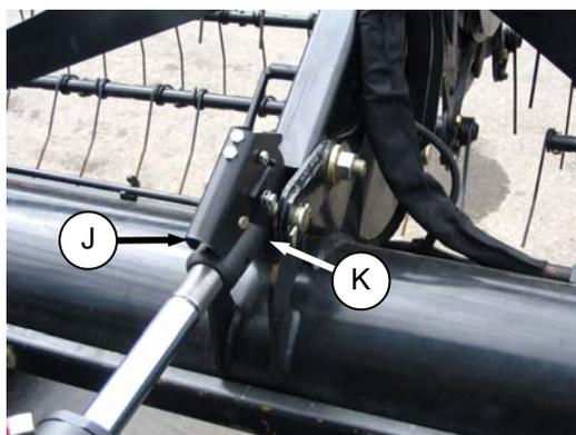
2. Отсоедините центральное звено, подняв расцепляющий механизм (J) и крюк подъема (K) с жатки.
