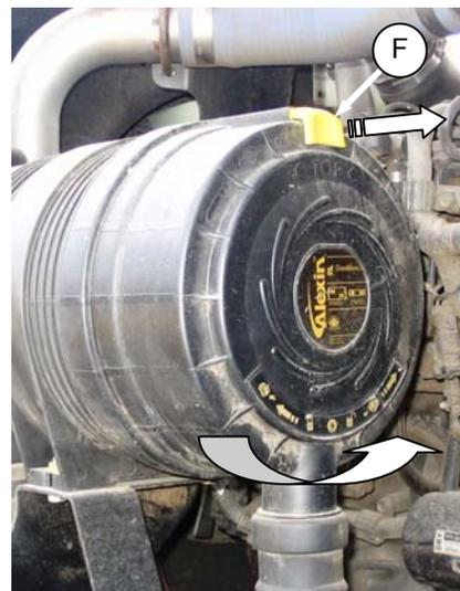
б. Поднимите желтую защёлку (F) и поворачивайте крышку против часовой стрелки, пока она не остановится .
