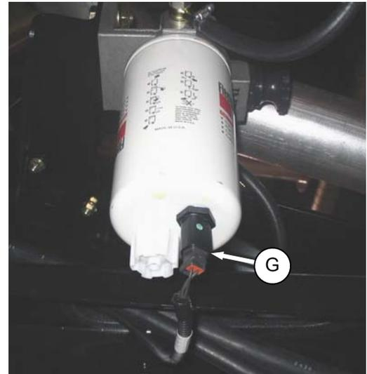
2. Отсоедините датчик Воды в Топливе (WIF) (G) в нижней части фильтра.
