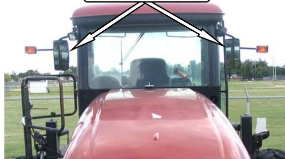
Два регулируемых внешних зеркала обеспечивают задний обзор.
