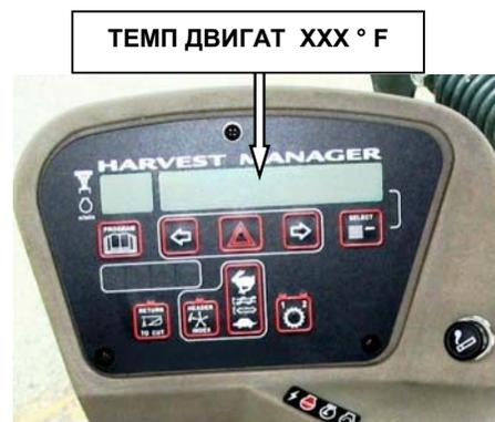
Нормальный рабочий температурный диапазон двигателя - 180°-225°F (82°-107°C), он определяется датчиком на консоли оператора. Если температура превышает 230°F (110°C), будет слышен постоянный прерывистый сигнал и на дисплее будет мигать сообщение "ENGINE TEMP". Сразу заглушите двигатель и определите причину. Сигнал прекратится и дисплей вернется в нормальный режим когда температура упадет ниже 225°F (107°C).
