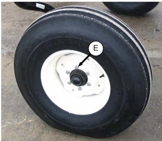
4. Выкрутите шесть болтов колеса (E) и снимите колесо со ступицы.
