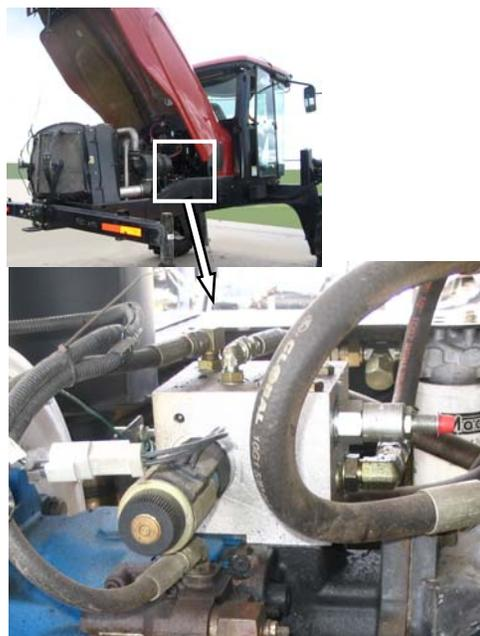
Клапан ВКЛ\ВЫКЛ на блоке клапанов регулирует скорость ножа и находится сверху насоса привода ножа. Поток на привод ножа механически устанавливается на самом насосе.
