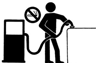
Никогда не производите заправку топливом с заведенным или разогретым двигателем.
