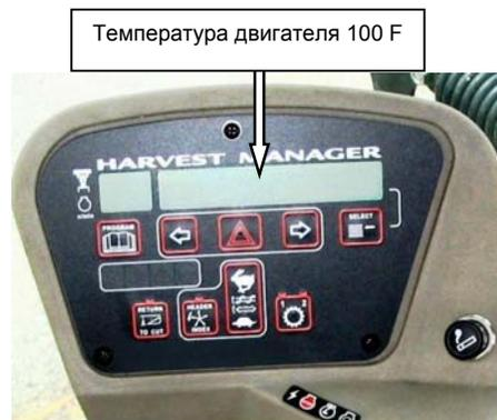
Дайте двигателю поработать с рычагом дросселя (C) в холостом режиме или близко к нему, пока термометр не покажет приблизительно 100°F (40°C).
