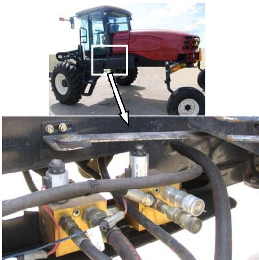
Блоки клапанов не требуют техобслуживания по графику, кроме проверки на наличие утечек масла и ослабленных электрических соединений. В случае необходимости техобслуживания .
