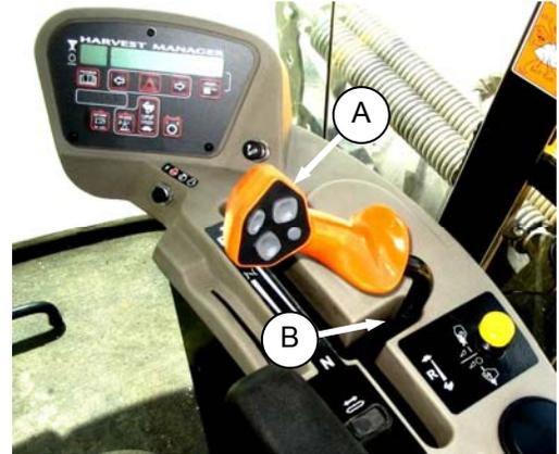
The Рычаг скорости (A) должен легко двигаться в N-DETENT (B) сам собой, и кабель (C) должен быть натянут когда рычаг скорости находится справа с краю в N-DETENT со стороны консоли. Концевик переключателя тоже должен быть полностью отжат. Если кабель перетянут, то это не даст полностью отжать нейтральный переключатель концевик и регулировочные болты на поворотном рычаге встанут не правильно.
