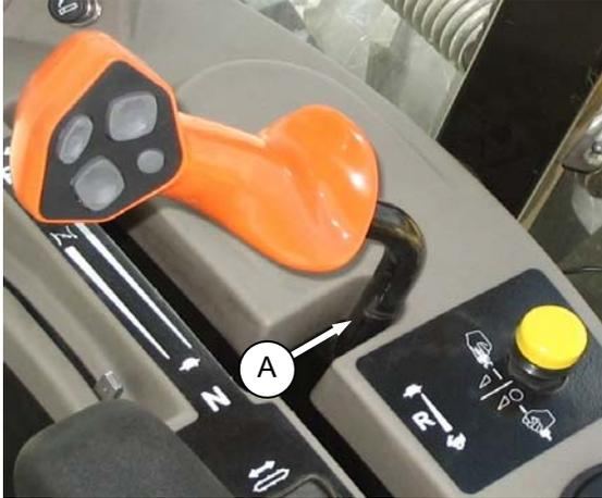
Рычаг скорости должен быть в прорези в положении N-DETENT когда руль отцентрирован и заблокирован. Если необходимо, отрегулируйте в следующем порядке
